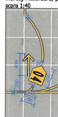
Detaliul 4 - marcaj intrare, marcaj identificare poziție, marcaj întoarcere, poz.04 scara 1:40
