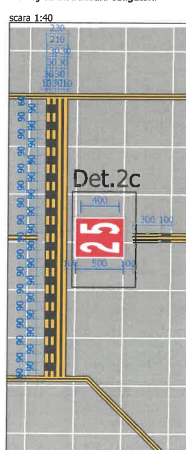
Detaliul 2 - marcaj poziție așteptare si marcaj cu instrucțiuni obligatorii scara 1:40
