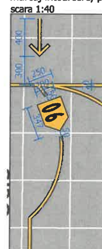
Detaliul 3 - marcaj intrare, marcaj identificare poziție, marcaj întoarcere, poz.06 scara 1:40
